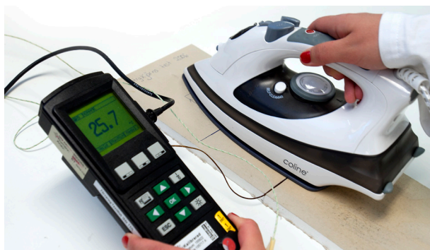
Tre prickar på strykjärnet bör innebära strax under 200 grader, men inget av de testade järnen kommer upp i 180 grader.
